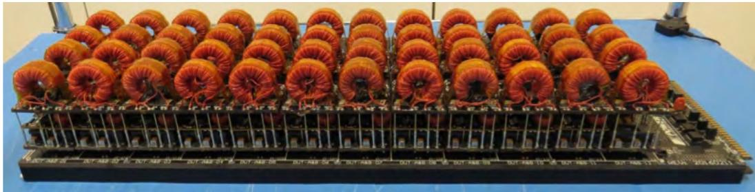
그림 7 PowiGaN InnoSwitch3 디바이스 인증 테스트에 사용되는 DOPL 스트레스 테스트 보드
