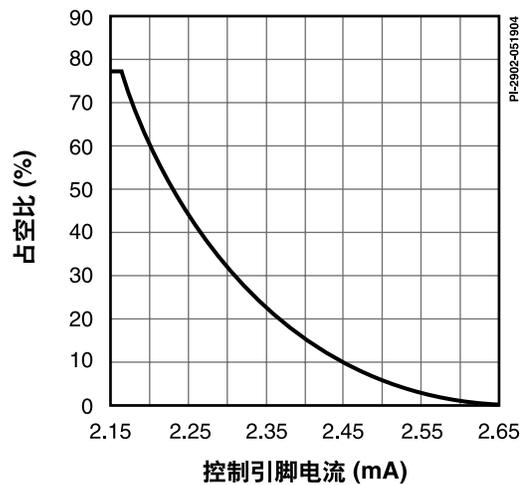
图16. 占空比与控制引脚电流之间的关系
