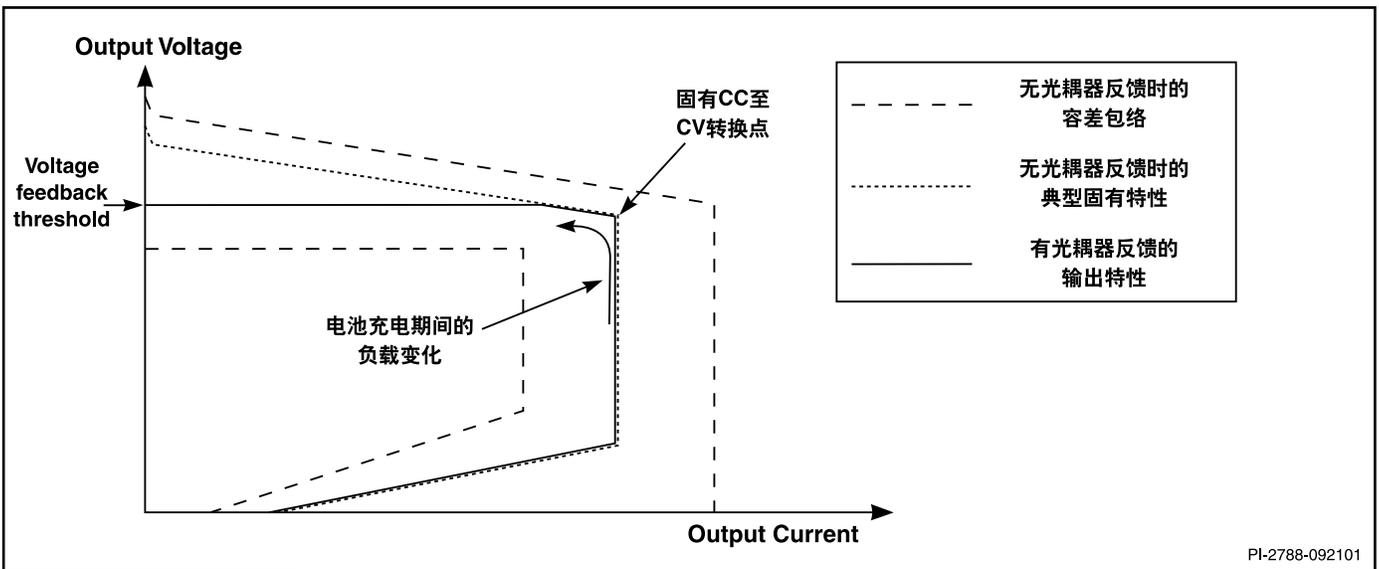
图7. 光耦器对电源输出特性的影响
