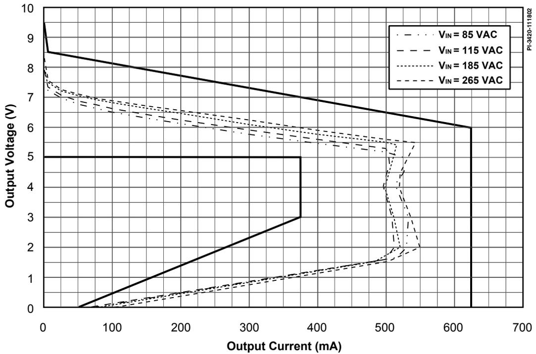
图10. 图9中所示电路测得的输出特性
