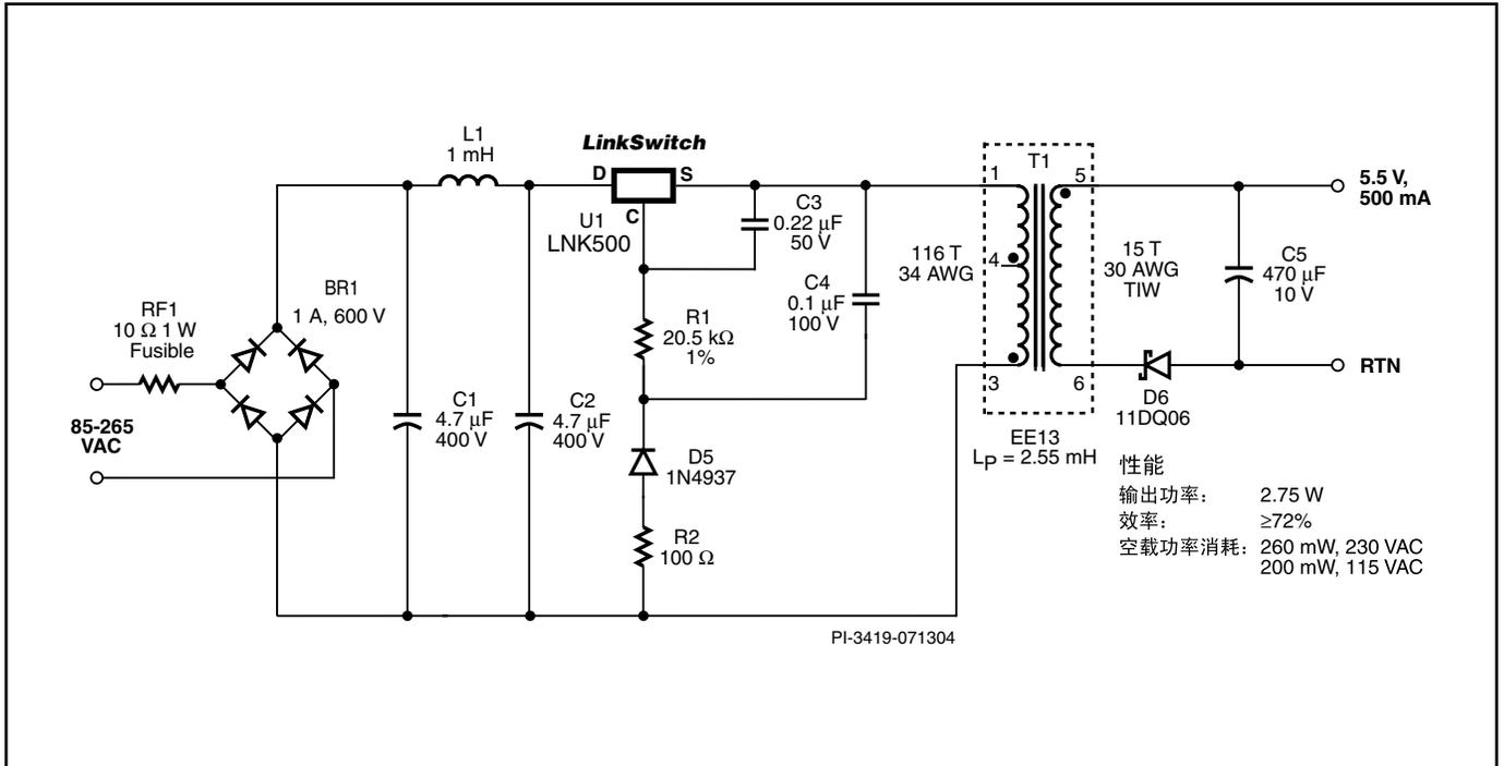
图9. 使用LinkSwitch的2.75 W恒压 / 恒流充电器
