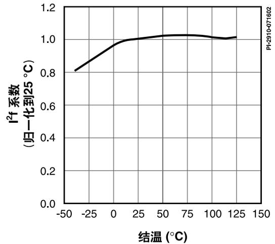
图20. P<sub>f</sub>系数与温度的特性曲线
