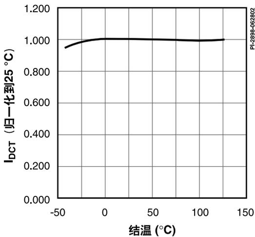
图21. I<sub>DCT</sub> 与温度的特性曲线
