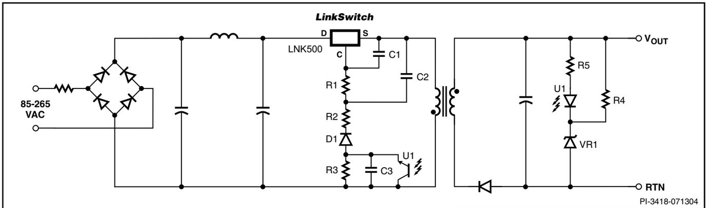
图6. 使用光耦器反馈的电源原理简图
