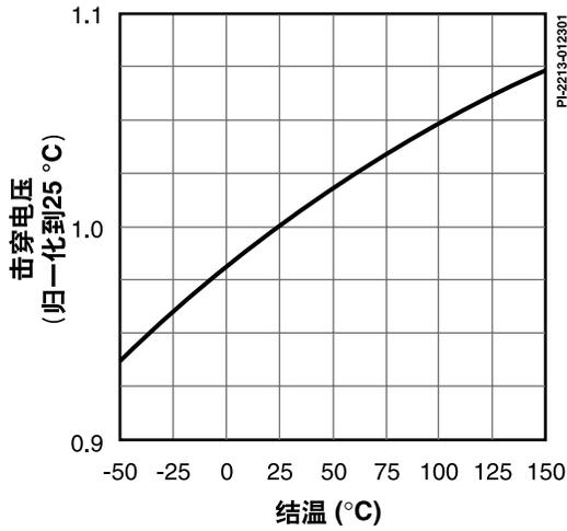
图17. 击穿电压与温度的特性曲线
