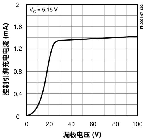
图13. IC 与漏极电压之间的关系
