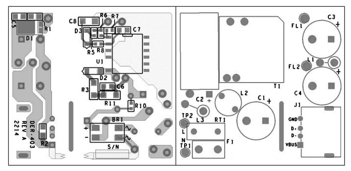
그림 5. K 패키지를 사용한 10W 설계를 보여주는 PCB(왼쪽 - bottom 레이어)(오른쪽 - top 레이어) 레이아웃 예제
