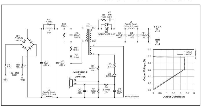
그림 4. 에너지 효율적인 USB 충전기 파워 서플라이(평균 효율 78%, 무부하 입력 전력 시 30mW 미만)
