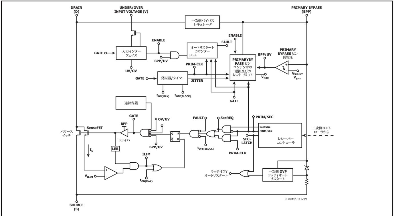
図 3. 一次側コントローラのブロック図
