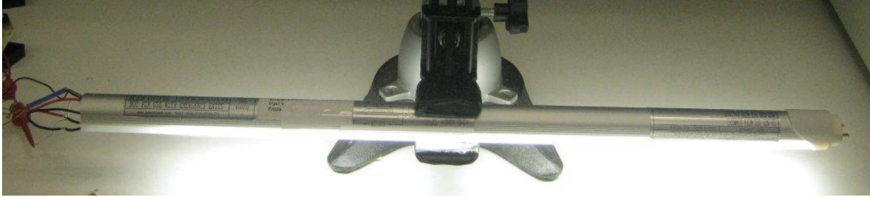
图16 – LED驱动器插入T8（2英寸灯管）进行热评估
