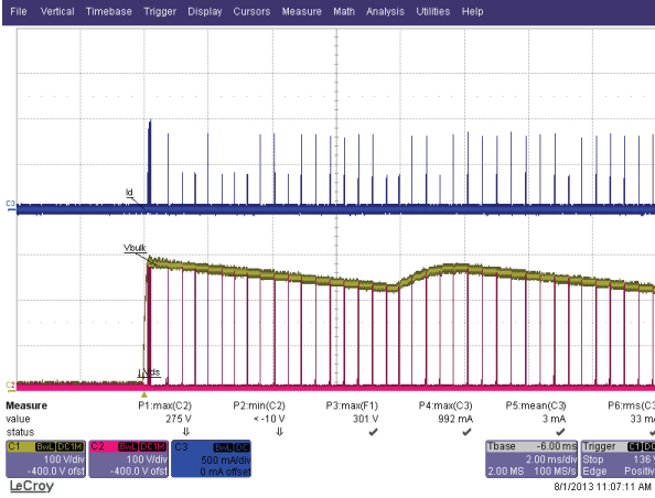
图33 – LYT0006D输出短路。190 VAC。 Ch1: V_{BULK} , 100 V/格 Ch2: V_{S-G} , 100 V/格 Ch3: I_{DRAIN} , 0.5 A/格 时间量程: 2 ms/格
