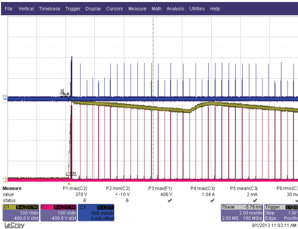
图35 – LYT0006D输出短路。265 VAC。 Ch1: V_{BULK} , 100 V/格 Ch2: V_{S-G} , 100 V/格 Ch3: I_{DRAIN} , 0.5 A/格 时间量程: 2 ms/格
