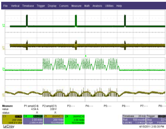
图27 – 90 VAC, 满载。 上: I_{\text{OUTPUT}} , 2 A/格 下: V_{\text{DRAIN}} , 200 V, 500 ms/格
