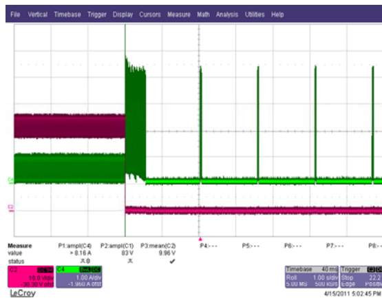
图29 – 110 VAC, 满载 上: I_{\text{OUTPUT}} , 1 A/格 下: V_{\text{DRAIN}} , 10 V, 1 s/格
