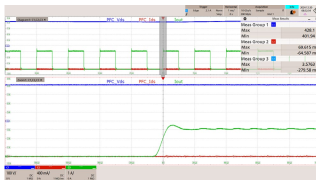
Figure 69 – 305 VAC, 50 Hz. 24 V / 0 A - 3.13 A Transient CH1: PFC_V DS , 100 V / div., 1 ms / div. CH2: PFC_I DS , 400 mA / div., 1 ms / div. CH3: I OUT , 1 A / div., 1 ms / div. Zoom: 20 μs/div. V DS MAX = 428 V I DS MAX = 69.6 mA
