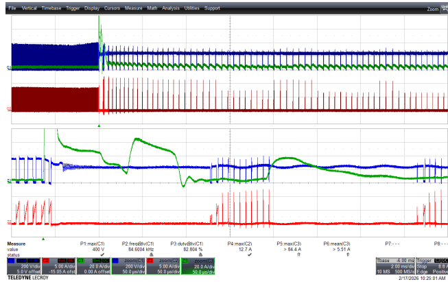
Figure 44 – 165 VAC, 50 Hz. Full Load – Short. CH1: V_{DS} , 200 V / div., 2 ms / div. CH2: I_{DS} , 5 A / div., 2 ms / div. CH2: I_{OUT} , 20 A / div., 2 ms / div. V_{DS} Max = 400 V I_{DS} Max = 12.7 A
