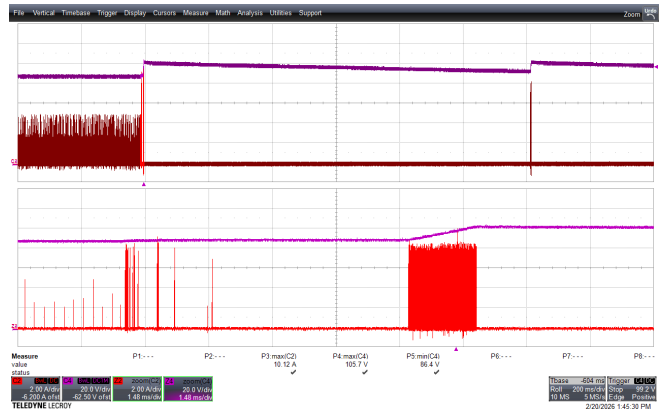
Figure 53 – 265 VAC, No Load. Output Overvoltage. CH2: I_{DS} , 2 A / div., 200 ms / div. CH4: V_{OUT} , 20 V / div., 200 ms / div. Zoom In: 1.48 ms / div. I_{DS\ max} = 10.1\ A V_{OUT\ Max} = 105.7\ V
