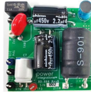
图 6. 工字型磁芯电感示例
