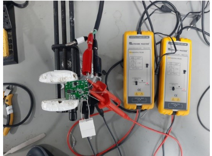
图 16. 使用电压测量方法的ZCD信号
