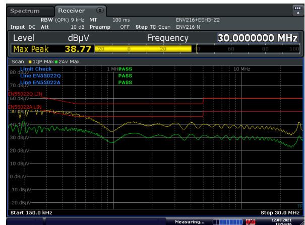
R_{Z1} 和 R_{Z2} 串联放置且更靠近输入端时EMI更低
