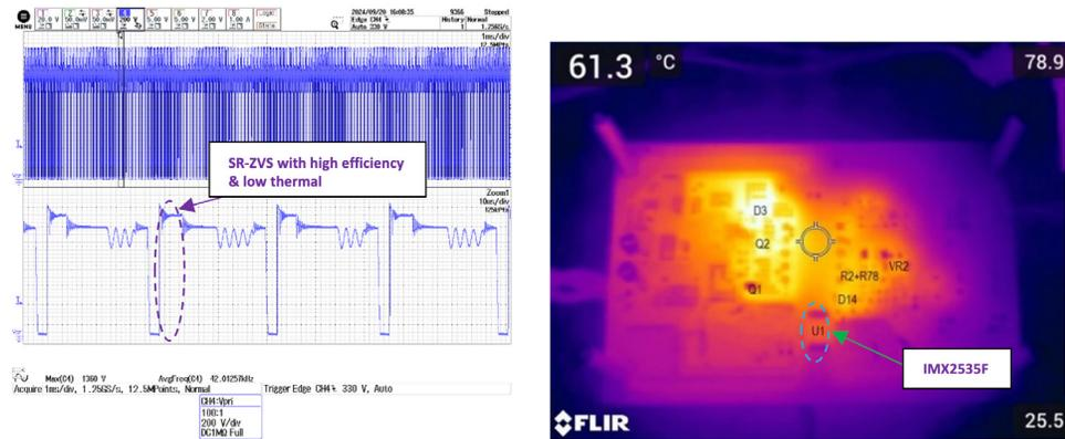
図 13.IMX2535F 及び 1000 V 入力を使用した 60 W のデザイン例
