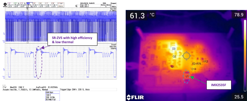
图13. 采用IMX2353F和1000V输入的60W参考设计
