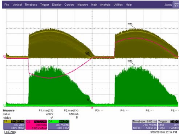
图41 – 230 VAC / 50 Hz, 45° 调光相位角 6个串联LED (18.2 V/350 mA) Ch1 (黄色) : VDS, 200 V/格 Ch2 (红色) : VIN, 200 V/格 Ch4 (绿色) : I_{DS} , 200 mA/格, 2 ms/格
