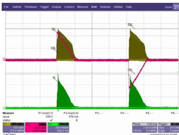
图39 – 115 VAC / 60 Hz, 135° 调光相位角 6个串联LED (18.2 V/350 mA) Ch1 (黄色): VDS, 100 V/格 Ch2 (红色): VIN, 50 V/格 Ch4 (绿色): I_{DS} , 200 mA/格, 2 ms/格
