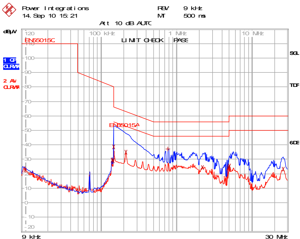
图81 – 预扫描 传导EMI, 最大稳态负载, 230 VAC, 60 Hz及EN55015限值。 注意: 蓝线表示相对于QP极限线的峰值结果 – 参见下表了解QP裕量。
