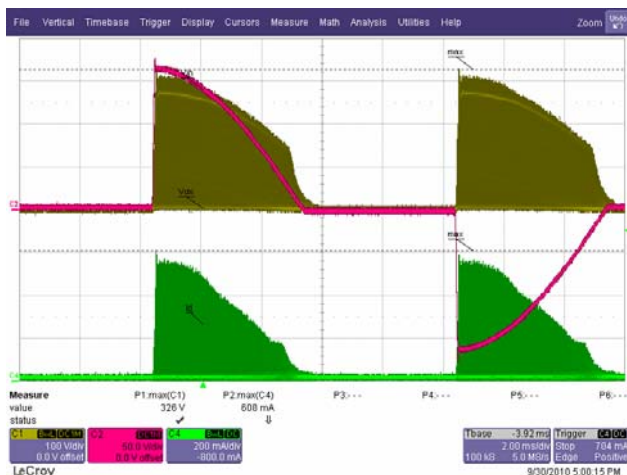
图37 – 115 VAC / 60 Hz, 90° 调光相位角 6个串联LED (18.2 V/350 mA) Ch1 (黄色): VDS, 100 V/格 Ch2 (红色): VIN, 50 V/格 Ch4 (绿色): I_{DS} , 200 mA/格, 2 ms/格
