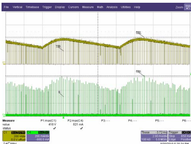
图47 – 265 VAC 负载短路 上: VDRAIN, 200 V/格 下: IDRAIN, 0.2 A/格, 2 ms/格
