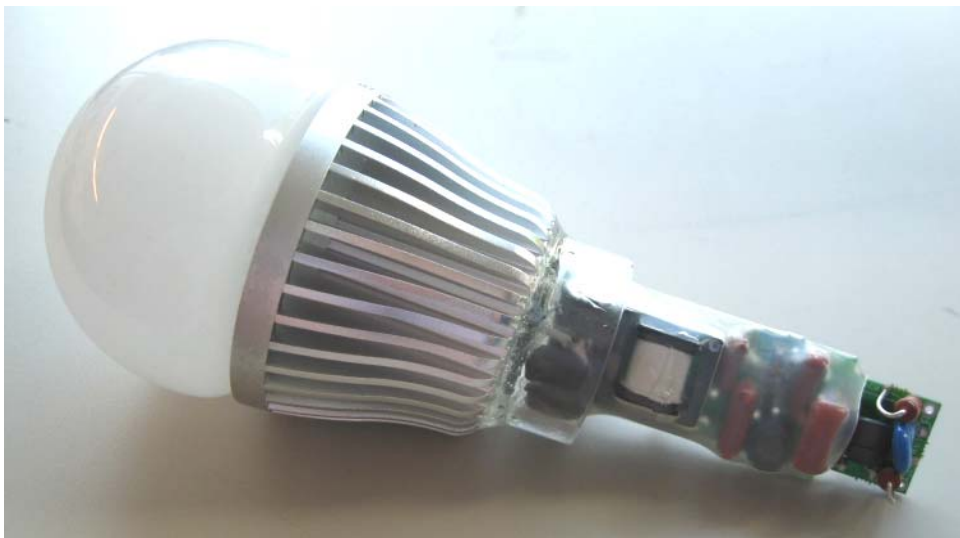
图3 - 用于A19 LED替换灯 (电路板从壳体中取出) 的RD-251示例
