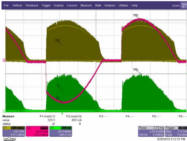
图35 – 115 VAC / 60 Hz, 45° 调光相位角 6个串联LED (18.2 V/350 mA) Ch1 (黄色): VDS, 100 V/格 Ch2 (红色): VIN, 50 V/格 Ch4 (绿色): I_{DS} , 200 mA/格, 2 ms/格
