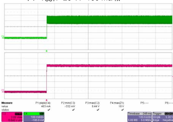
图24 – 265 VAC, 50 Hz, 输出上升 上: I_{OUT} , 100 mA/格 下: V_{OUT} , 20 V, 100 ms/格
