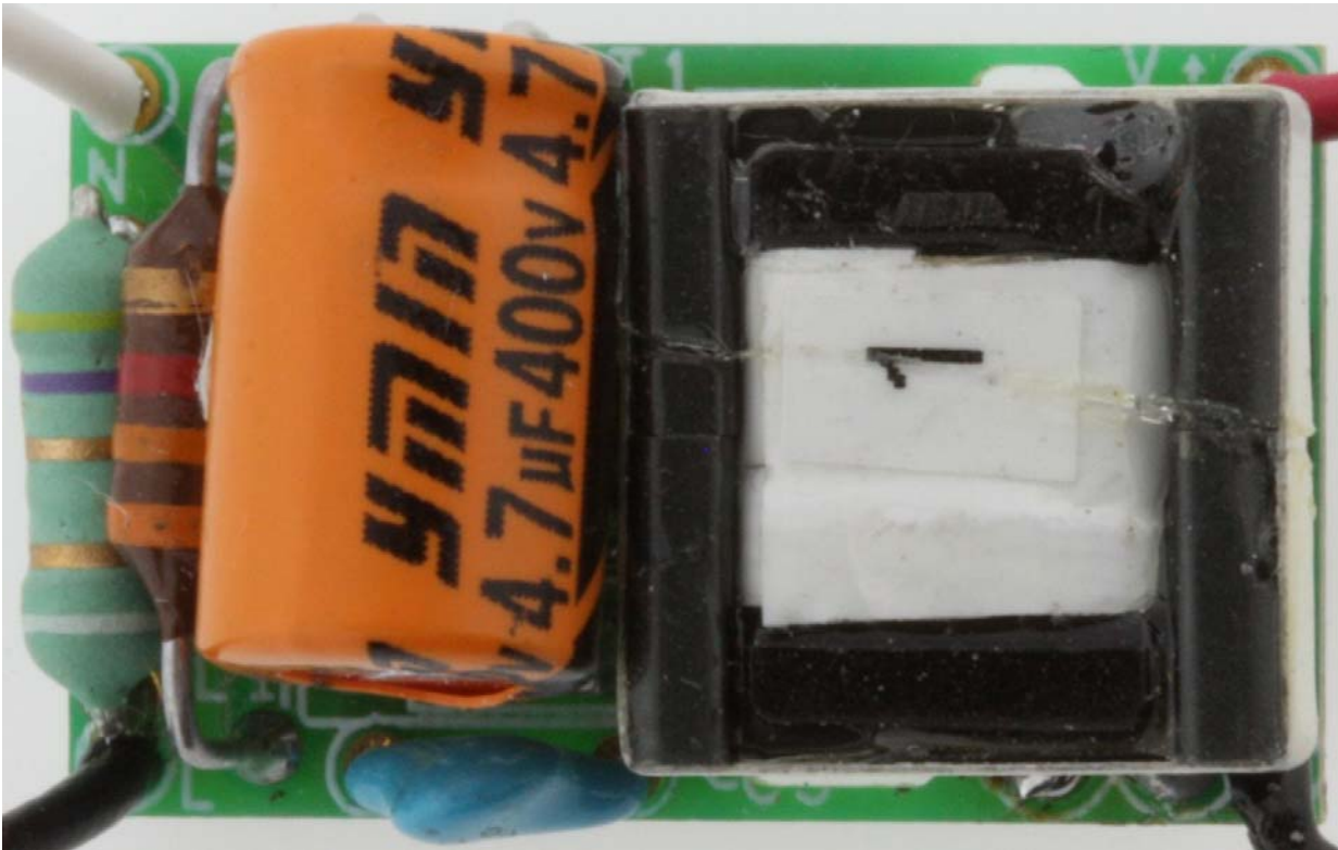
图1 – 装配后的电路板（顶视图）(1.02" [26 mm] x .63" [16 mm])
